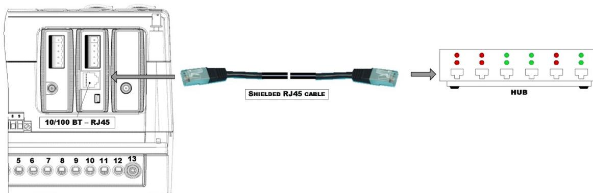
Рис.17 Подключение прибора через Ethernet
