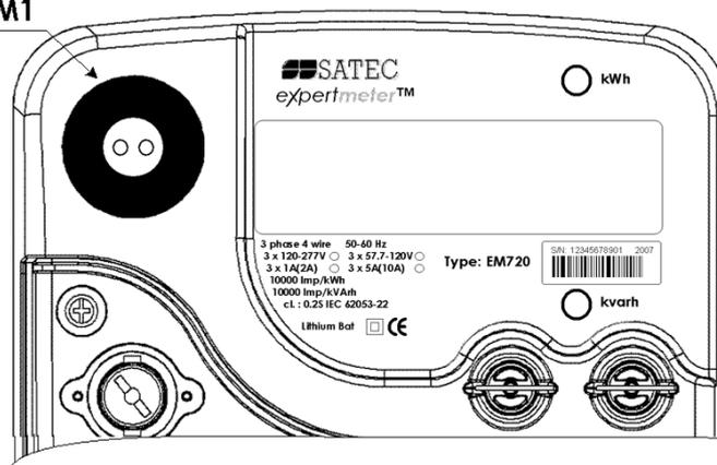
Рис.14 Расположение инфракрасного порта связи на корпусе прибора
