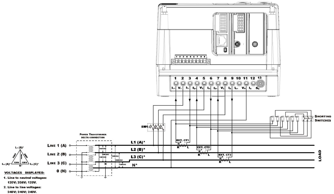
Рисунок 12 - Четырехпроводное прямое соединение треугольником, использующее 3 трансформатора тока (4LN3 или 4LL3)
