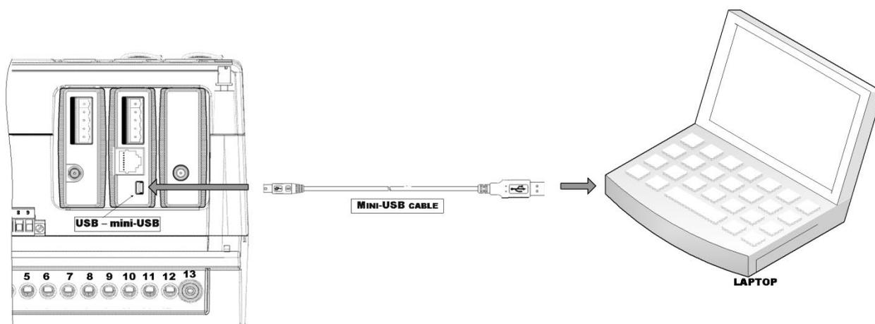
Рис.18 Подключение прибора через USB
