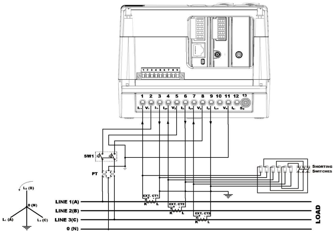
Рисунок 10 - Четырёхпроводное соединение звездой, использующее 2 трансформатора напряжения, 3 трансформатора тока (3LN3 или 3LL3)
