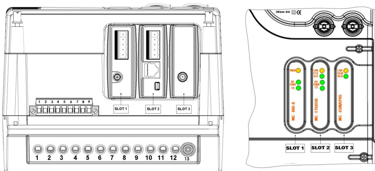
Рис.19 Расположение слотов для подключения дополнительных модулей
