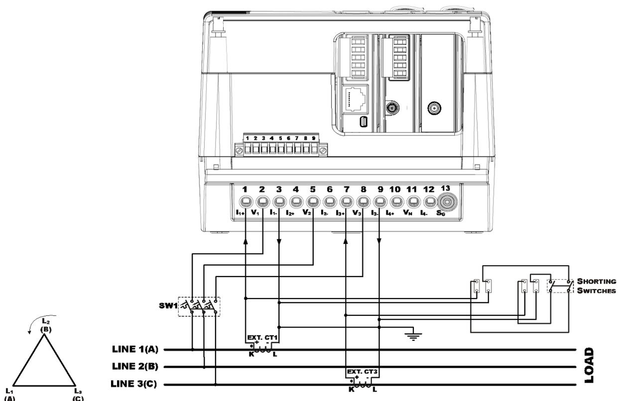
Рисунок 6 - Трёхпроводное прямое соединение с использованием 2 трансформаторов тока (3DIR2)
