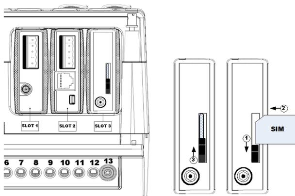
Рисунок 20: модем GSM/GPRS порт связи – COM2
