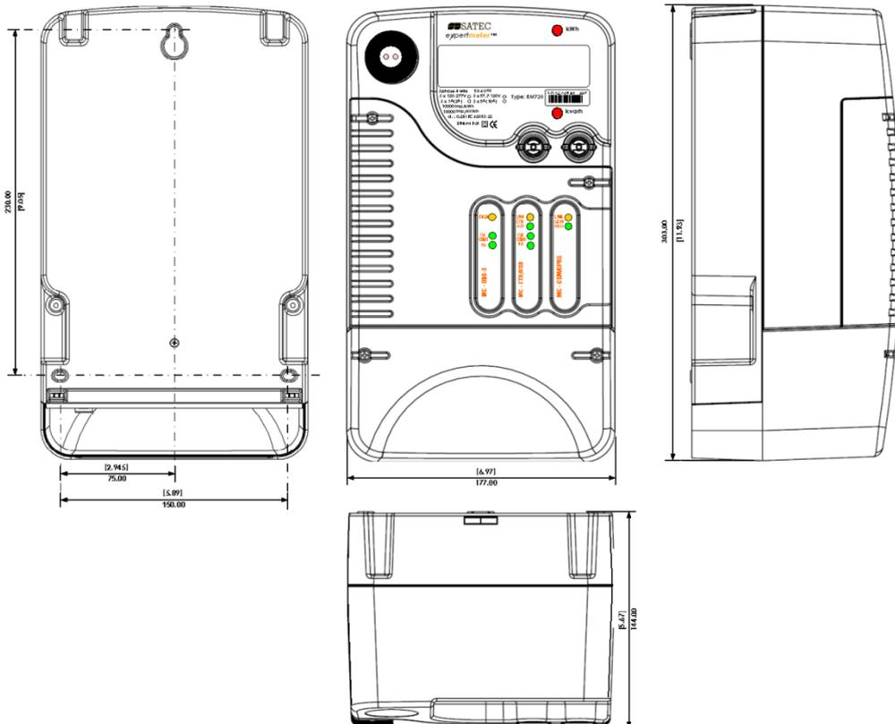
Рис.1 Размеры прибора
