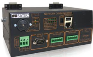
El servidor de datos ETC-II permite el registro de datos de equipos en modo isla, utilizando el protocolo Modbus (como maestro Modbus). Se puede definir un total de 64 rangos de direcciones.
